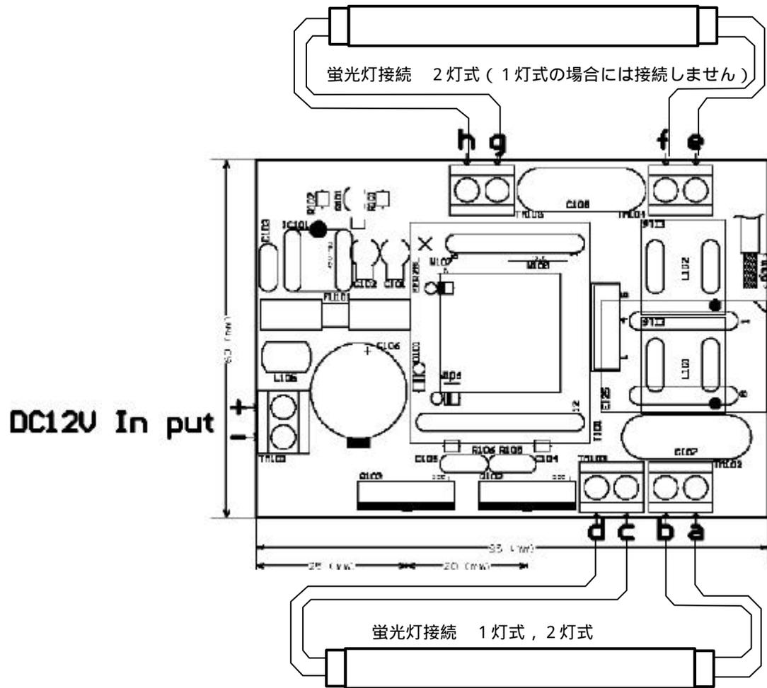
FA - AC シリーズ パワートランジスタの放熱面は基板端面より1.0mm内側へ入っております。
